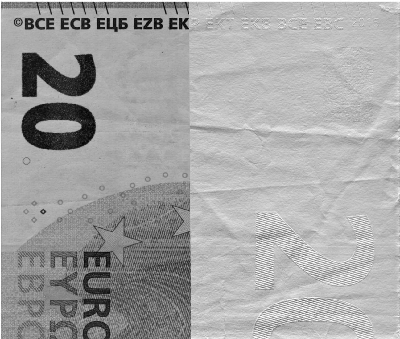
Abbildung 3 xposure:photometry - 3D Oberflächenscan. Hochperformante Inline Inspektion von Sicherheitsdokumenten z.B. Banknoten
