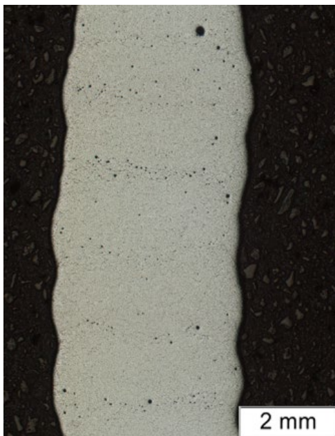
Abb. 2: Ausschnitt eines polierten Querschliffs aus einer waDED Probenwand.
