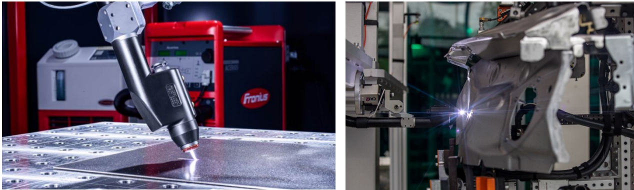
Bild 2: HAP Behandlung (links) und Beispiel einer punktuellen Plasmareinigung vor dem Bolzenschweißen (rechts)
