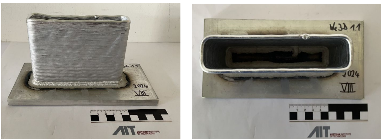
Abb. 1: Rechteckige Hohlzylinder-Coupons gefertigt mittels waDED aus der Legierung AA2024.
