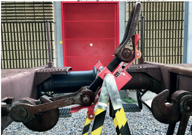
BILD 4: Automatisches Entkuppeln einer Schraub- enkupplung
