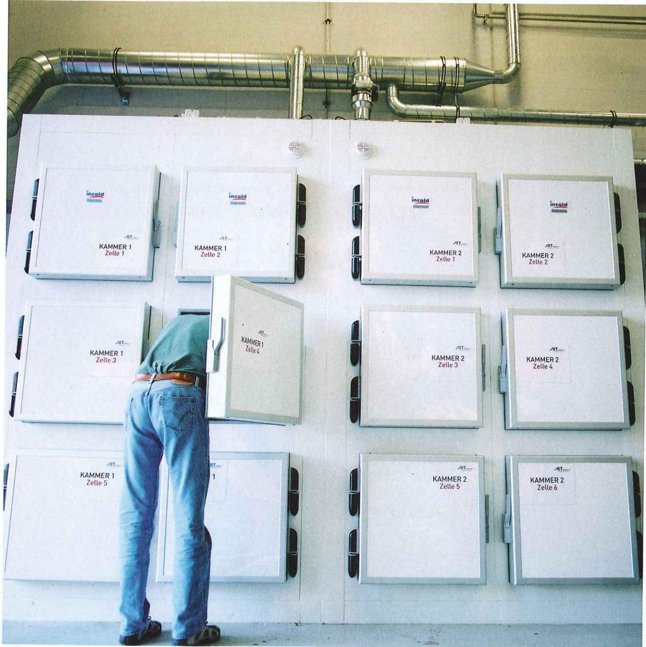
**Batterielabor:** Hier werden die Stromspeicher Langzeittests unter allen denkbaren Bedingungen unterzogen.
