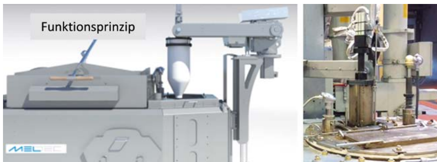
Bild 2: CAD-Modell des kommerziell verfügbaren Meltec Dosiersystems (links), Einsatz im Serienbetrieb (rechts)
