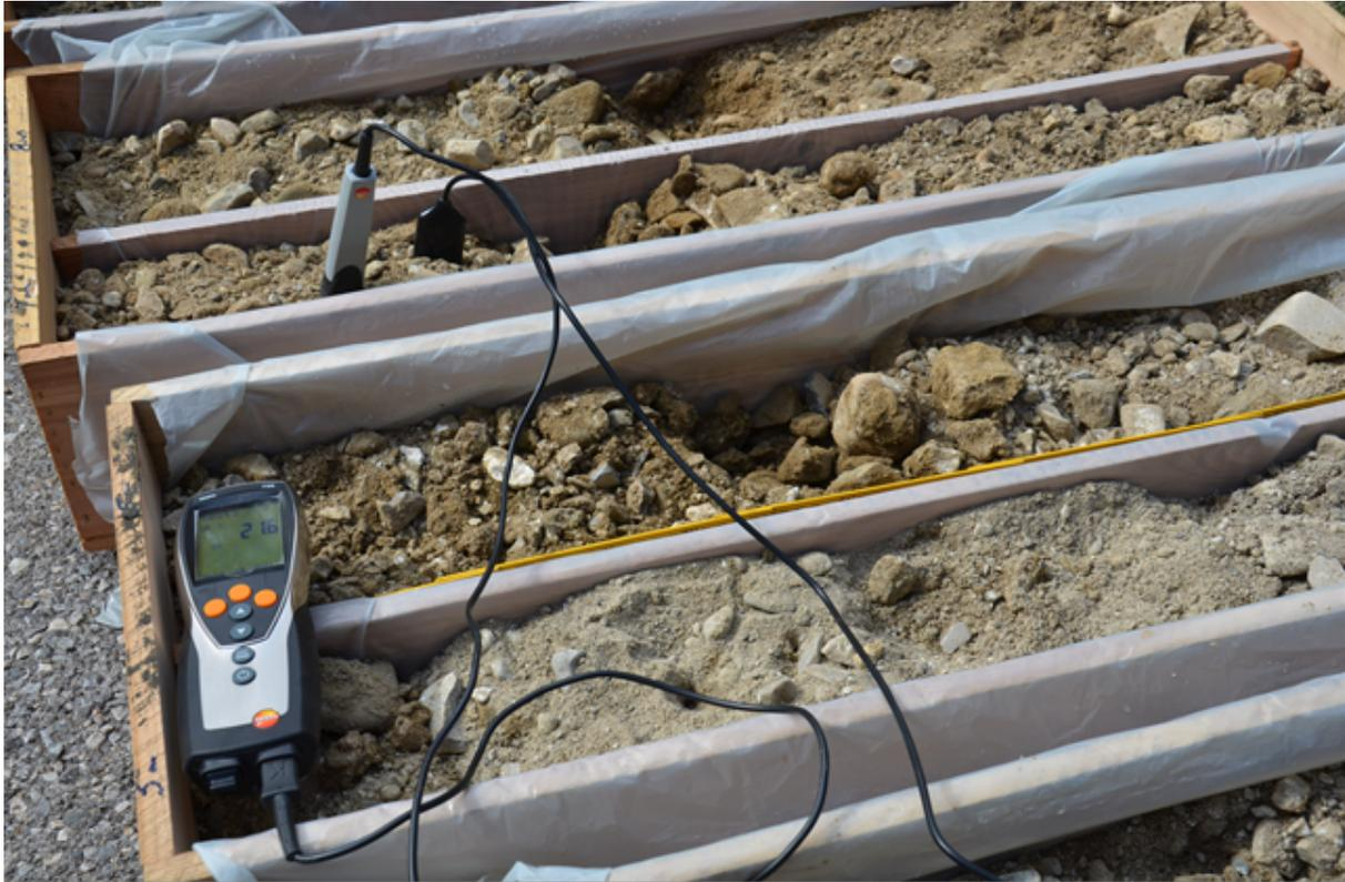
Abbildung 12: Bodenfeuchte-Messung an den Bohrkernen
