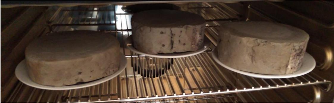
Abbildung 15: Trocknung der Bohrkernproben bei 105 °C in einem Laborofen
