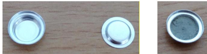
Abbildung 17: links: Tiegel und Deckel aus Aluminium; rechts: Tiegel gefüllt mit Bohrkernprobe
