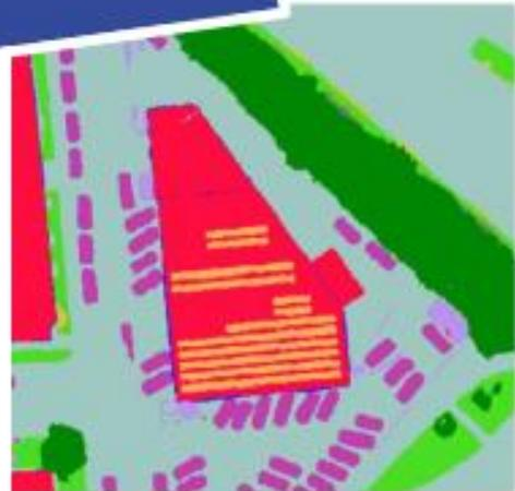
BASIS für die Berechnung von „tatsächlicher“ Bodenversiegelung oder IST-Bestandserhebung von m<sup>2</sup>-Solar-Panelen vom gesamten Stadtgebiet
