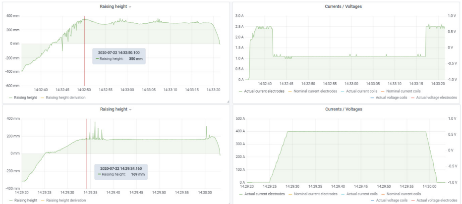
Abb. 12: Steighöhen (linke Spalte) und Verlauf der Kurzschlussströme (rechte Spalte) am Beispiel der Versuche 194 (untere Zeile, 0.4T/400A, 4 s Dauer der Stromrampe, 30 s Haltezeit Kurzschlussstrom) und 195 (obere Zeile 0T/0A); jeweils 320 mbar in 20 Sekunden
