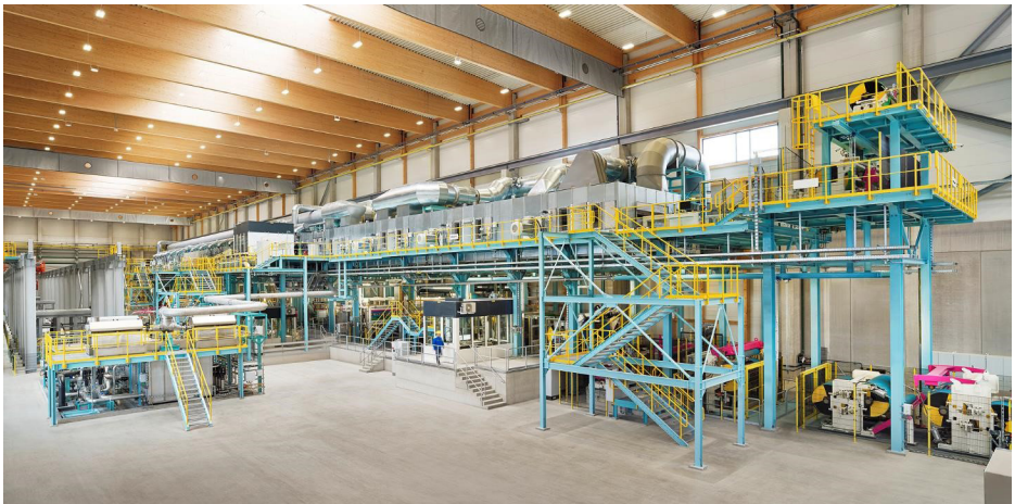
Abb. 7: Banddurchzugssofen 4 - eine der 15 AMAG-Großanlagen, welche im Rahmen der Big Data Projekte analysiert werden
