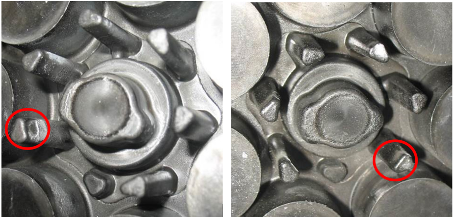
Abb. 4: Der Zustand des Kerns nach 15.000 (links) und 32.000 (rechts) Gießvorgängen. Zu sehen ist lediglich ein sehr leichtes Ankleben der Aluminiumschmelze an den Domen (rote Kreise), vor allem in ihren oberen Bereichen, die nicht so effizient gekühlt werden.
