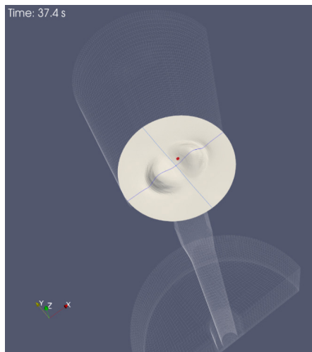
Abb. 3: Extraktion der Profildaten und der Steighöhe aus der Simulation [Versuchsparameter nicht ident mit jenen aus Abbildung 2].
