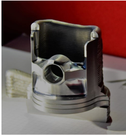
Abb. 4. Demonstrationsobjekt gefertigt aus der entwickelten Al-Zn-Mg-Cu Legierung mittels WAAM Prozess hergestellt: bewusst nur halbseitig befräster Kolben.
