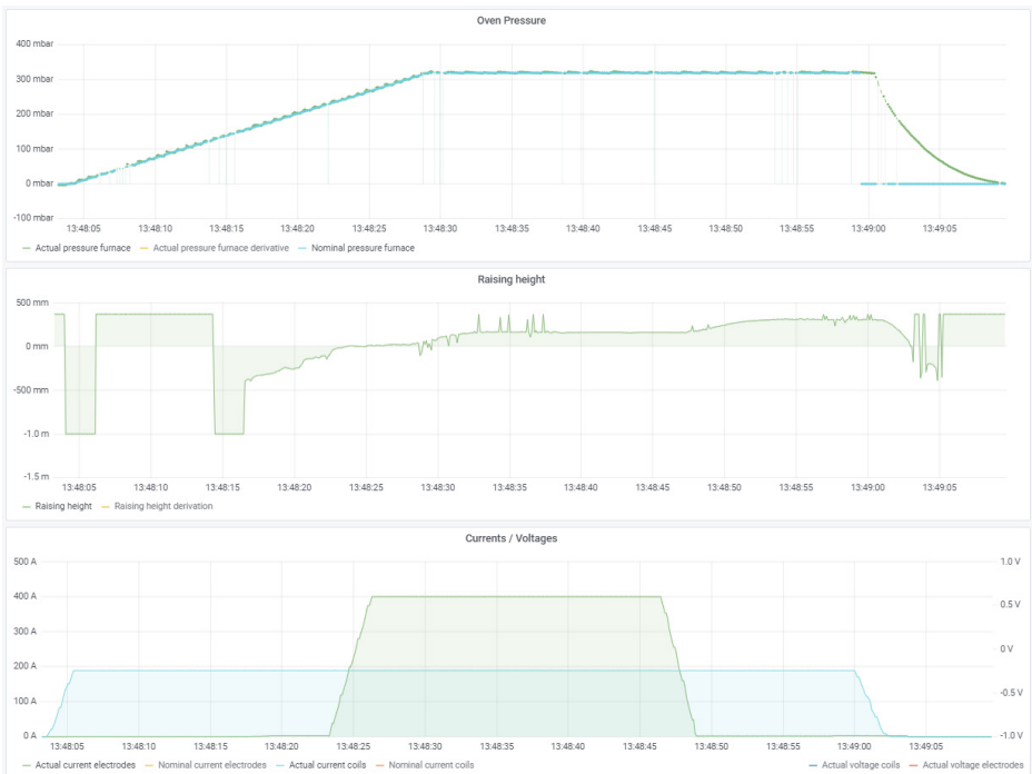
Abb. 10: Druckkurve, Steighöhe und Stromverläufe am Beispiel des Versuchs 185 (400 mT B-Feld, max. 400A Kurzschlussstrom erreicht in 3 Sekunden, 20 Sekunden Haltezeit Kurzschlussstrom, 318 mbar in 25 s, Druckhaltezeit 30 s).
