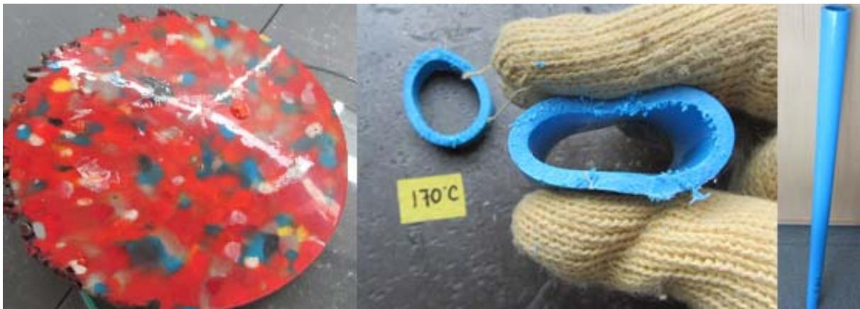
Abbildung 1: Links: Probenkörper aus PA6 Mahlgut, bei dem die Schmelzbarkeit unter drucklosen Bedingungen (wie in einem PCM-Speicher gewünscht) getestet wurde. Rechts: Formstabilen PEX. Bei Erhitzen des in Rohrform verfügbaren Materials bleibt es in seiner ursprünglichen Form. Es kann zwar deformiert werden, ist aber elastisch, sodass es seine Ursprungsform wieder annimmt.
