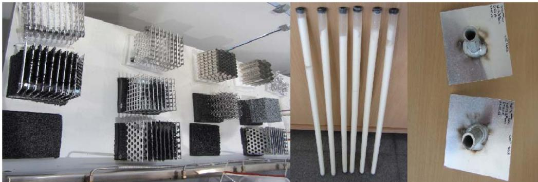
Abbildung 7: Links: Tests von verschiedenen Polymer-Wärmeleitstruktur. Mitte: Makroverkapselte PCM-Rohre werden von einem Wärmeträgerfluid umströmt; unterschiedliche Rohregeometrie und Anordnung erlaubt einstellbare Leistungen und Speicherdichte. Rechts: Das Konzept des Proof of Concepts ist eine Kombination aus Aluminium-Wärmeleit-Strukturen und C-Stahl-Rohren.
