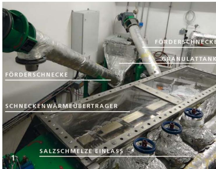
Abbildung 6: Speicherkapazität und Speicherleistung sind bei diesem Kompakt-Wärmetauscherkonzept getrennt und erlauben so potentiell günstige Hochleistungs-PCM-Speicher<sup>13</sup>.
